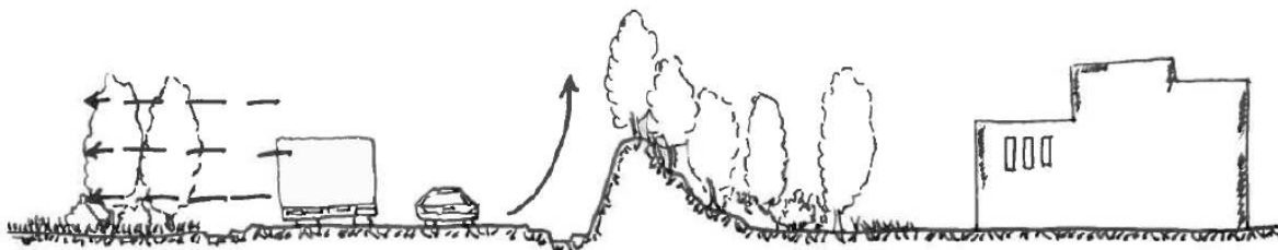
Esempio di effetto di attenuazione determinato dalle fasce di vegetazione associate anche alla formazione di terrapieni (in particolare per le aree prossime ad edificato residenziale esistente o in progetto)
